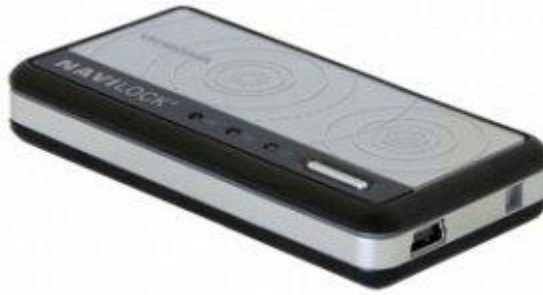
Obrázek 7: externí GPS přijímač NAVILOCK BT-359 komunikující přes Bluetooth. převzato z http://p.gzhls.at/212834.jpg
